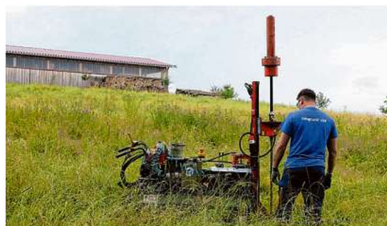
Im Sommer liefen Erdbohrungen am Riederholz bei Heiningen, wo eine Freiflächenfotovoltaikanlage aufgestellt werden soll. FOTO: ROLF BAYHA
